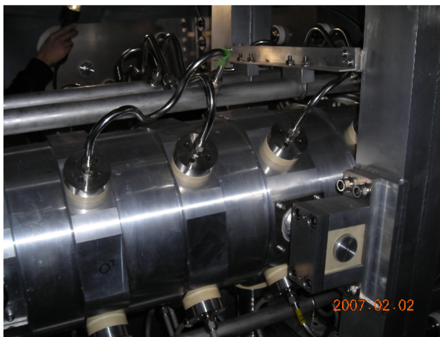
図 A.3: 電磁ホーンの写真。(上)全体写真。(下)外管および冷水ノズル。
