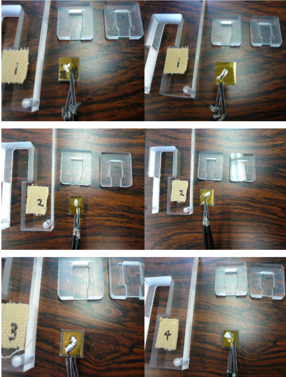
図 5.29: CVD ダイヤモンド 検出器サンプルの電極写真。(上) Dia1。 (中) Dia2。 (下) Dia3, 4。
