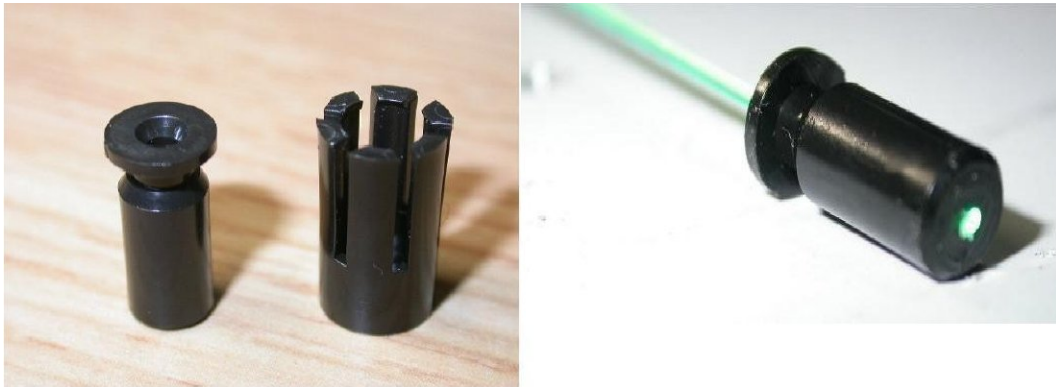
図 3.9: ファイバーと GOMI コネクタ。右の写真のようにコネクタとファイバーを一体化させる。もう一方のコネクタには MPPC が装着されており、この 2 つを取りつけることでファイバー端面と MPPC を密着させる。
