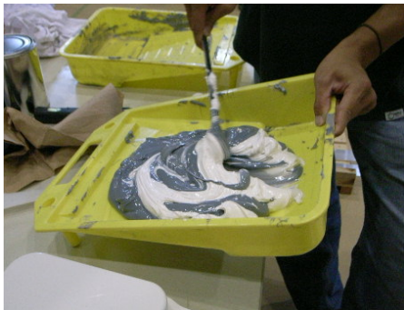
図 4.3: 接着剤を2 : 1の割合で混合する
