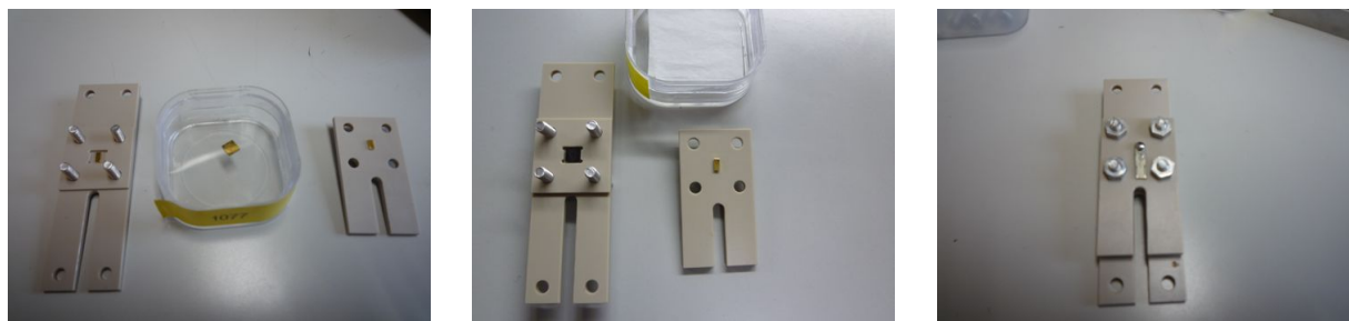
図 4.5: ミューオンモニターに設置したダイヤモンド検出器の写真。(左) ダイヤモンドチップを乗せる前。(中央) 金属ピンの上に乗せた後。(右) PEEK 材のパッケージで挟み込み、ネジ止めしたもの。
