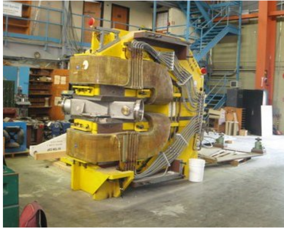
図 23 磁気スペクトロメータ用電磁石 PACMAN
