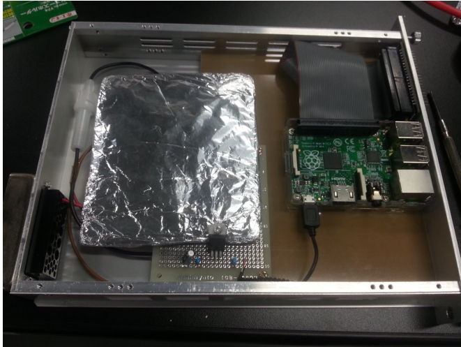
図 84 Raspberry Pi を動作させるための NIM モジュール (内部)
