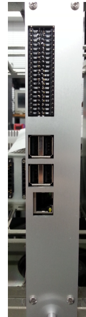
図 85 Raspberry Pi を動作させるための NIM モジュール (正面)
