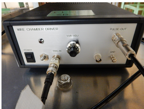
図 80 Artek 社製 HV Switching 回路
