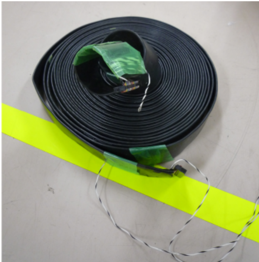
図 3.55: Radeka2 段型アンプ-電源供給基板間のフラットケーブルの写真 .
