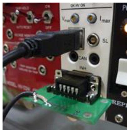
図 6.6: iseg 電源のフロントパネルにある inhibit D-sub コネクタの写真 .
