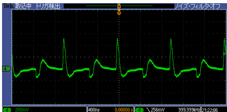
図 3.47: バイポーラ・トランジスタ Q2, Q3, Q4, Q5 に NXP 製の BSV52 を用いた場合のテストパルス出力。
