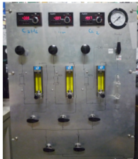
図 2.11: MWPC にガスを送るためのガス・システムの写真 .
