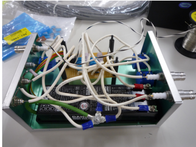
図 6.5: 組み立てられた Behlke モジュールを用いた HV スイッチングモジュールの写真 .
