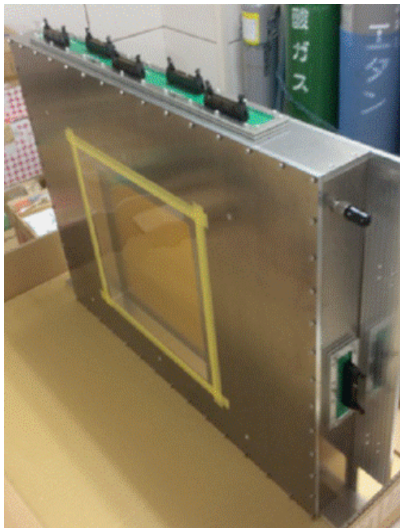
図 2.16 DeeMe 実験に用いられる MWPC の外観．
