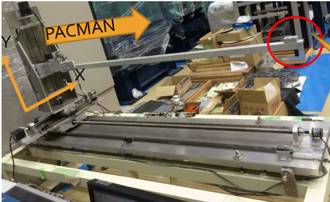
図 3.6 駆動装置．ステージには z 方向のレールがついている．アームにホールプローブを取り付けて測定を行う．
