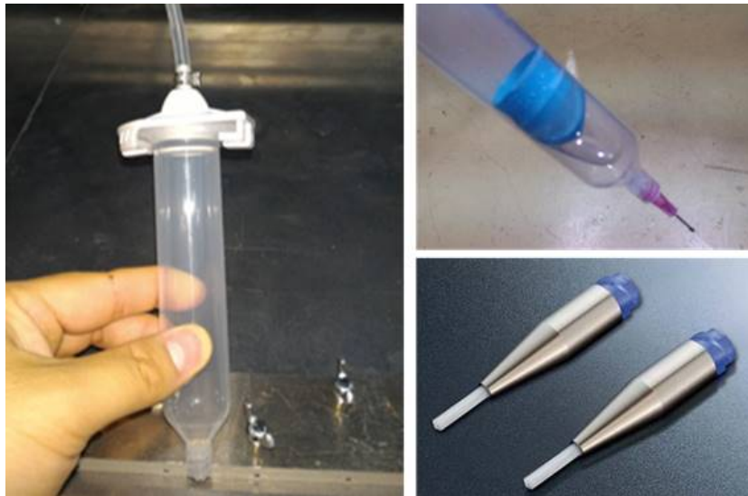
図 53 シリンジ (左) とシリンジに付けるノズルとプランジャー (右上) と刷毛ノズル (右下)
