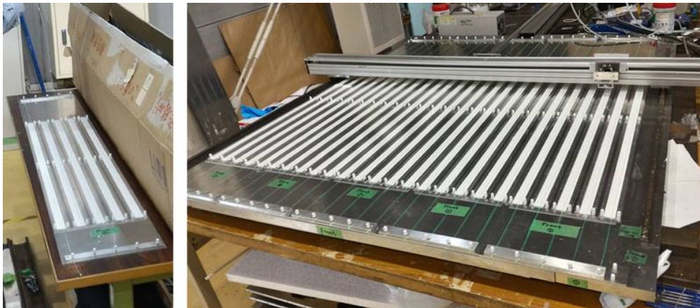
図 46 アルミ板にシンチレータを乗せた様子
