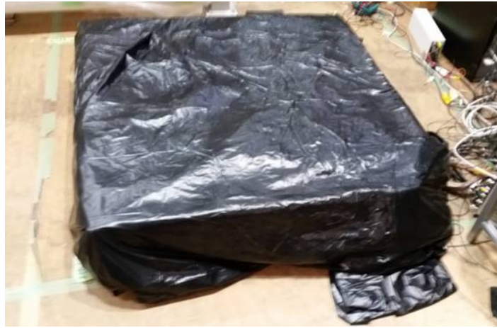
図 108 Sub Module を遮光した様子
