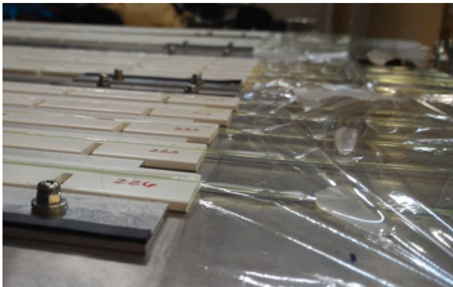
図 57 塗布を行わない部分をラップで覆う様子
