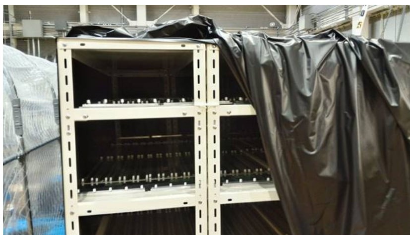
図 47 接着や反射剤を塗布したシンチレータの保管場所
