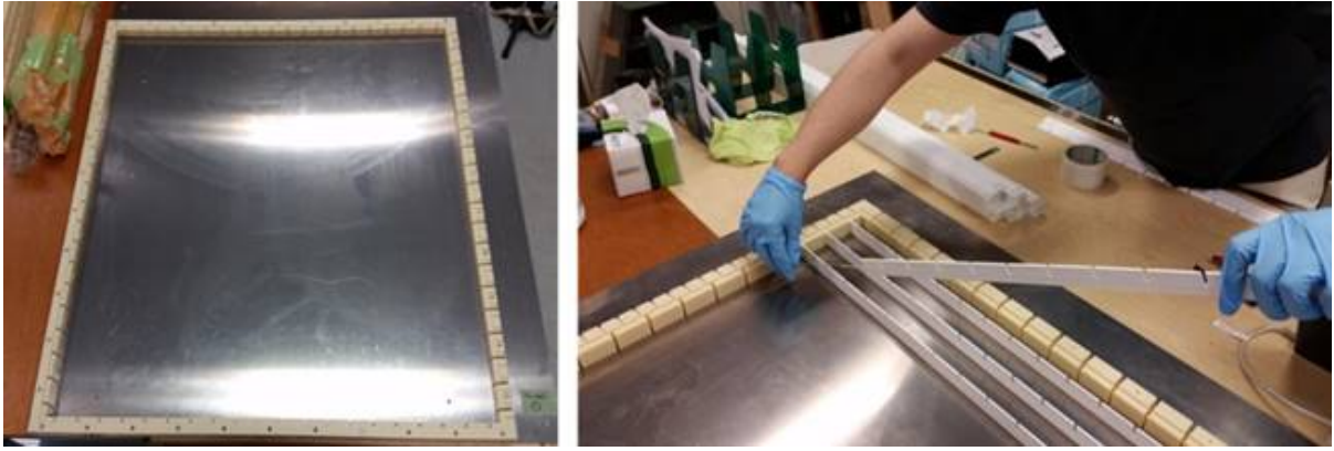
図 65 ABS 樹脂で出来たフレーム (左) とそれにシンチレータを組み立てている様子 (右)
