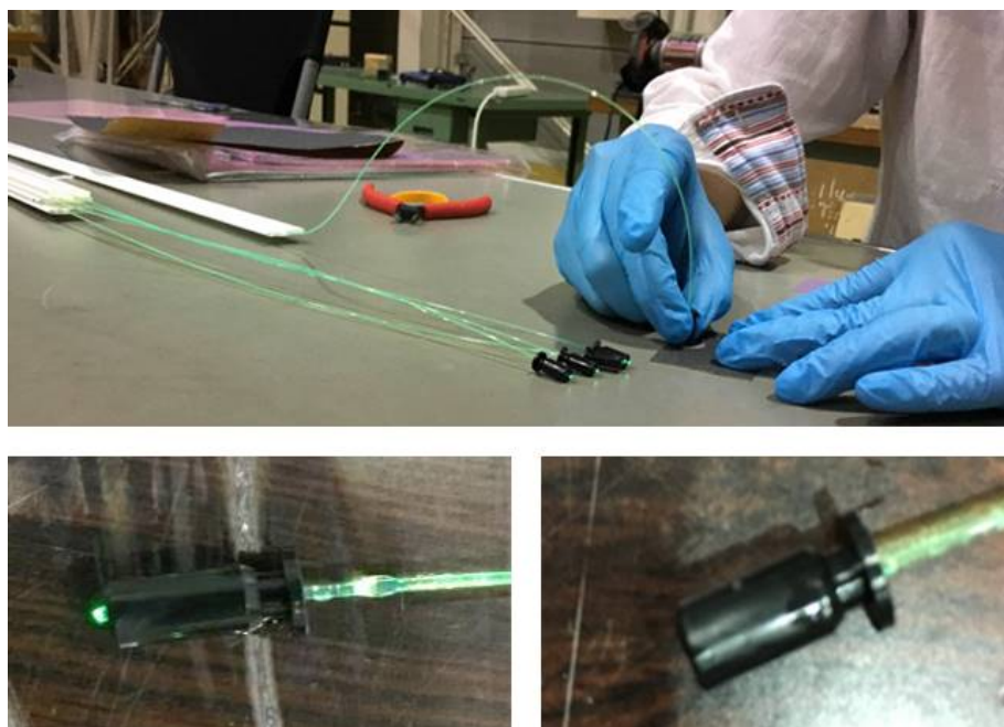
図 82 研磨の様子 (上) とファイバーの端面の様子 (左: 研磨前、右: 研磨後)
