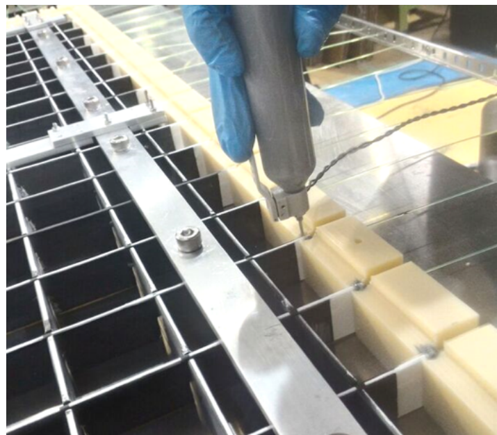
図 2.12 グリッドシンチレータの固定. シリコングルーを使用し ABS 樹脂フレームとシンチレータを接着する.
