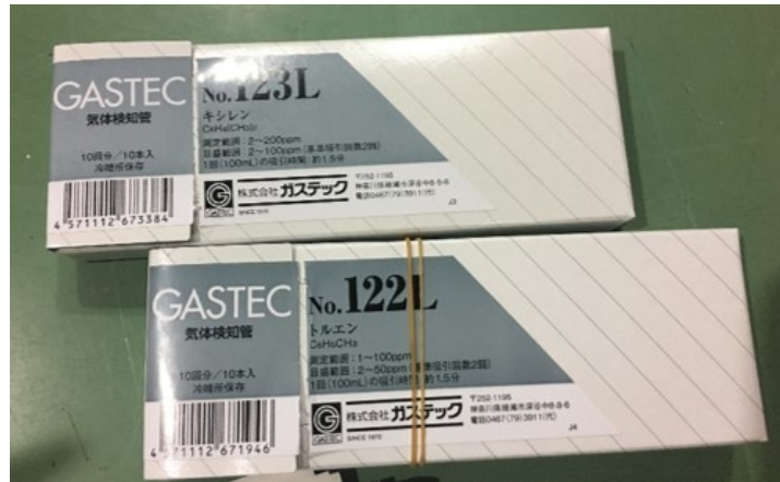
図 3.34 気体検知管 キシレン用とエチルベンゼン用.
