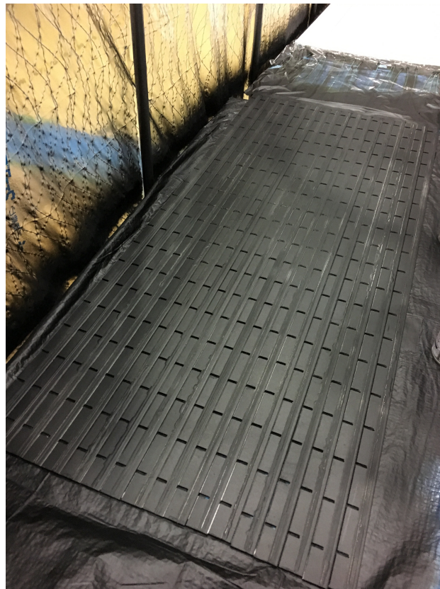
図 3.20 二度塗り後のシンチレータ
