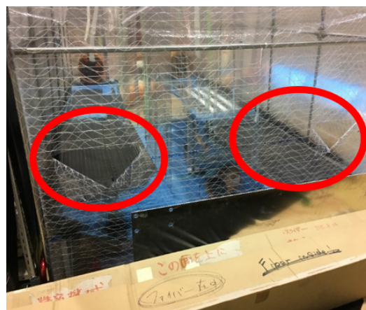
図 3.27 新たな吸気口の様子。シンチレータを配置する直線上に空気の流れができるように穴を開けた。
