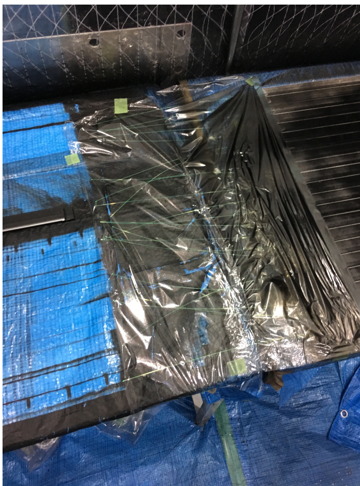
図 3.17 ファイバーの保護. ラップを用いて黒塗料の付着を防ぐ.
