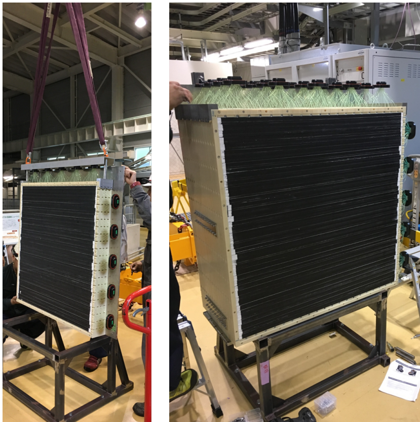
図 2.16 Module 組み立ての様子。 Sub-Module を一つずつ接続させていく。 Module 接続完了の様子（右図）
