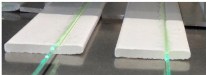
図 2.3 シンチレータとファイバーの様子. ファイバーがシンチレータの溝部分に挿入され接着されている.
