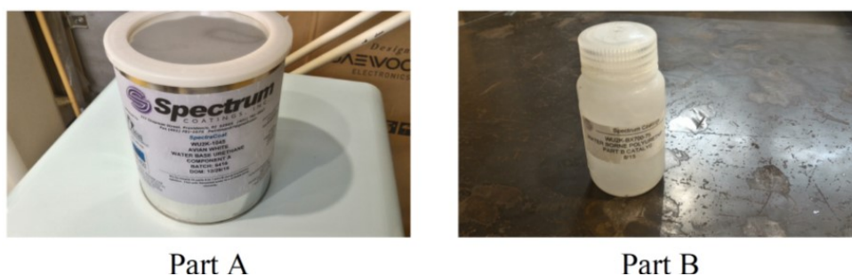
図 2.5 反射材. 主剤 (左) 硬化剤 (右) (Avian Technologies 社の Avian-D[35])
