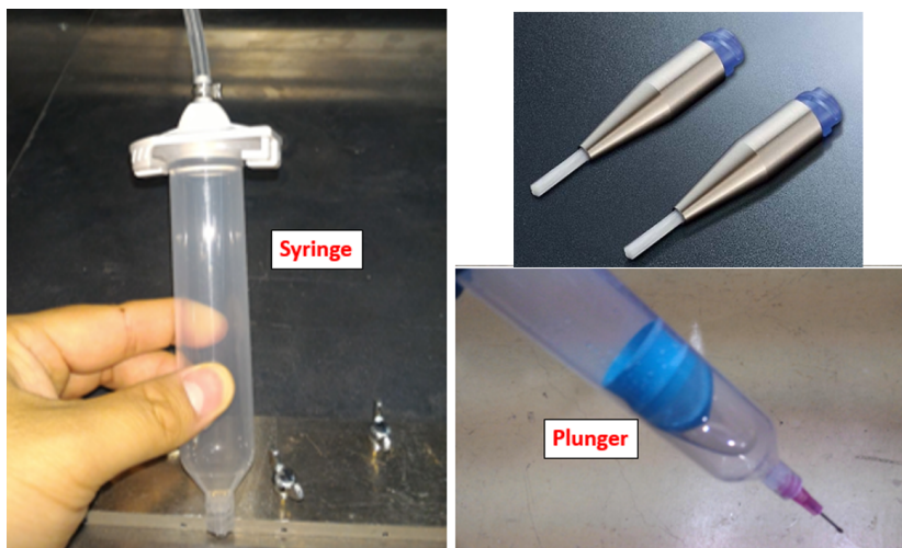
図 2.7 塗布に使用するシリンジ（左）とノズル（右）。ディスペンサーに接続される。反射材塗布時に使用する刷毛ノズル（右上）、ファイバー接着に使用するノズル（右下）
