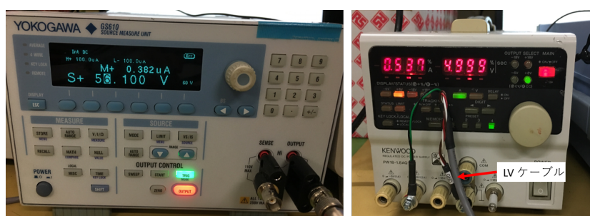
図 4.21 試験に使用した供給電源。 MPPC への電源供給用 (左), 各ボードへの電源供給用 (右)
