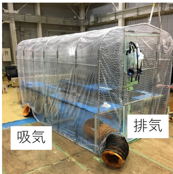
図 3.25 排気法改善前の様子。吸気用と排気用で電気送風機を使い分けていた。また配置場所は机の下であった。
