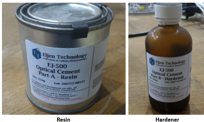
図 2.4 オプティカルセメント. 主剤と硬化剤 (Eljen Technology EJ-500) [34]
