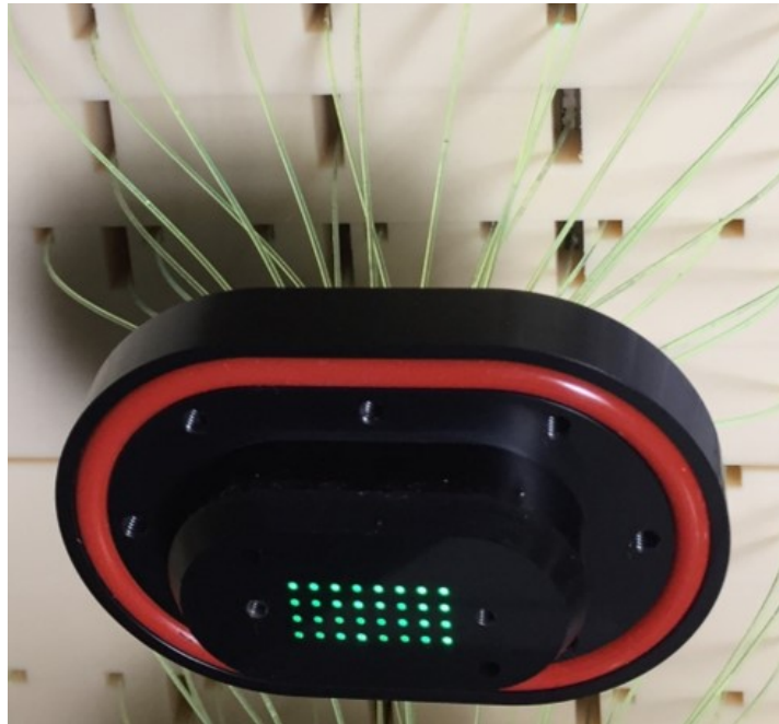
図 1.24 ファイバーバンドルとファイバーの関係. 32本のファイバーをまとめて、バンドルに挿入する. Oリングをバンドルに取り付けて水漏れを防ぐ.
