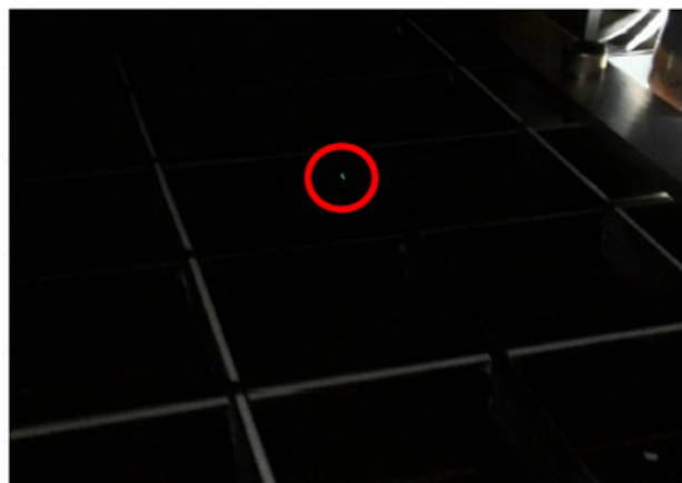
(b) 反射剤を削った部分の光漏れ
