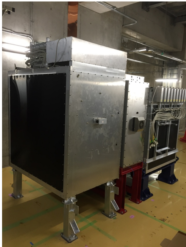
図 63: WAGASCI 検出器 (左からプラスチック標的 (Proton module)、水標的 (Wagasci module)、MRD(INGRID))
