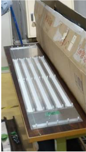
(a) プラスチックシンチレータをアルミ板へ 設置した様子
