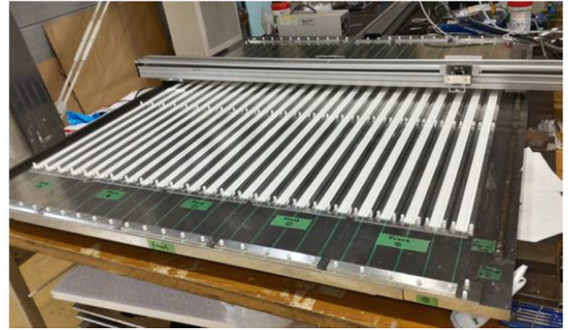
(b) 25 枚のプラスチックシンチレータを設置 した様子
