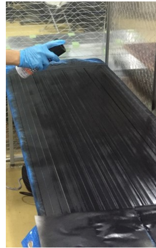
図 48: プラスチックシンチレータに黒塗料を塗布している様子
