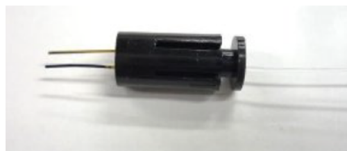
図 34: 部品を組み立てた後の GOMI コネクタ
