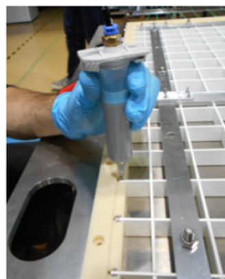
図 54: グリッドシンチレータを ABS フレームに接着する様子
