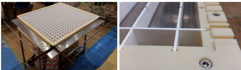
図 52: y 方向にグリッドシンチレータをはめた様子
