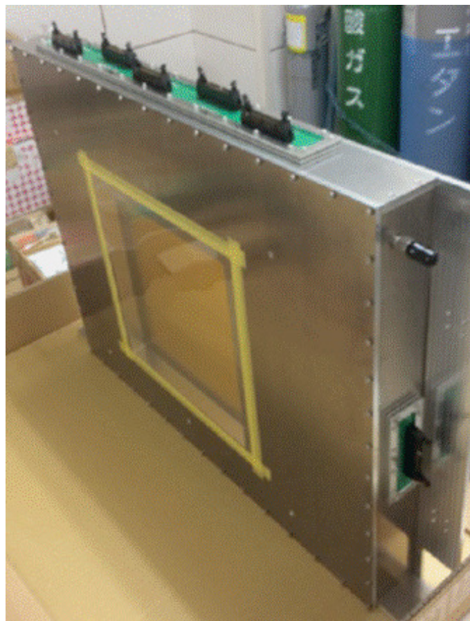
図 2.13: DeeMe 実験に用いられる MWPC の外観。
