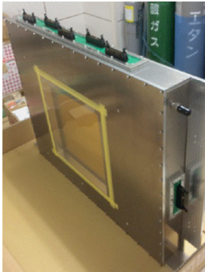
図 2.13: DeeMe 実験に用いられる MWPC の外観。
