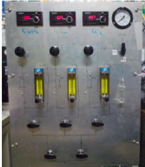
図 2.8: MWPC にガスを送るためのガスシステム.
