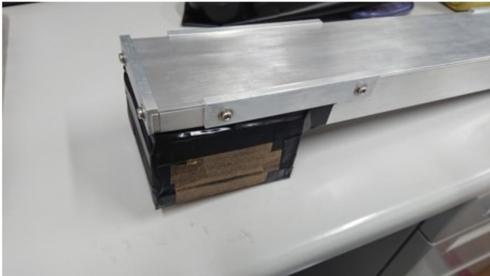
図 8.8: 背面に取り付けた光吸収ボックス.
