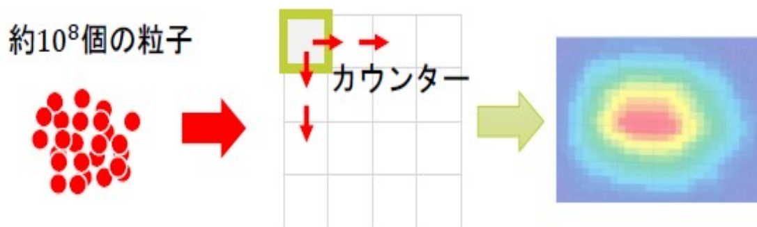
図 3.4: パルスビームに対してソロカウンター方式を用いた場合.
