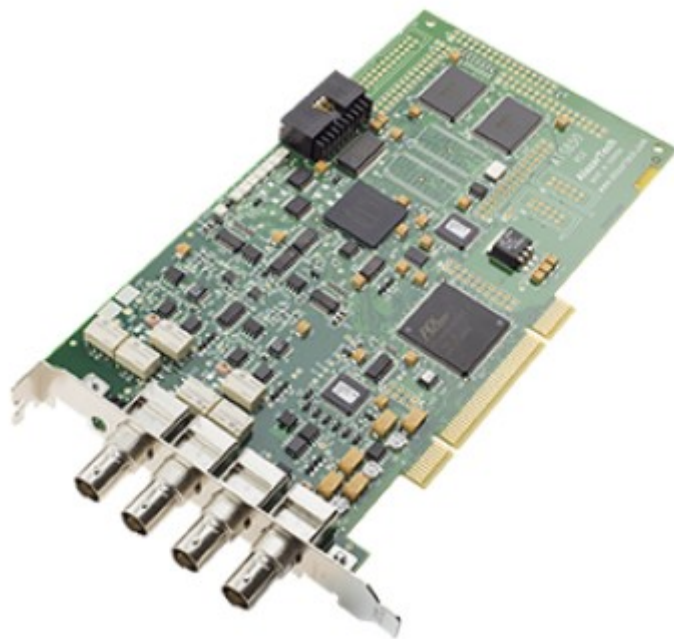
図 6.7: Alazar Tech 社の ATS850-8 bit,50 MS/s.
