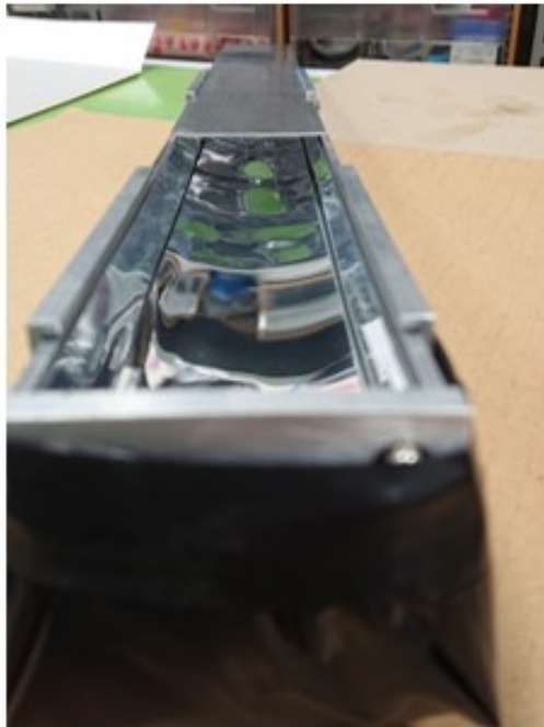
図 8.6: ライトガイド内壁のアルミ平板 (中の様子).
