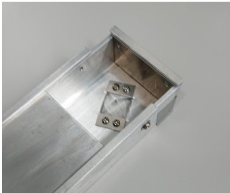
図 8.3: ライトガイド (アクリル設置部分).
