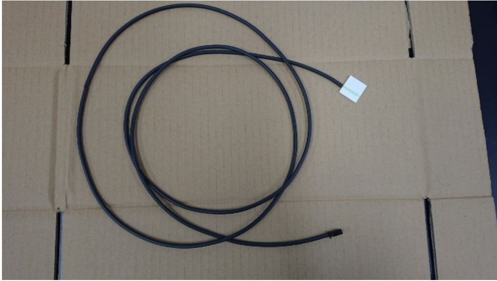
図 4.8: プラスチックシンチレーターに波長変換ファイバーを接着したもの.
