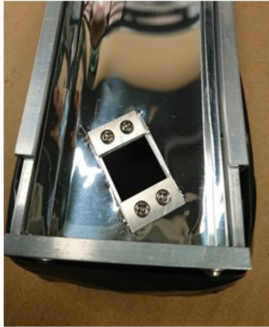
図 8.5: ライトガイド内壁のアルミ平板 (アクリル設置部分).
