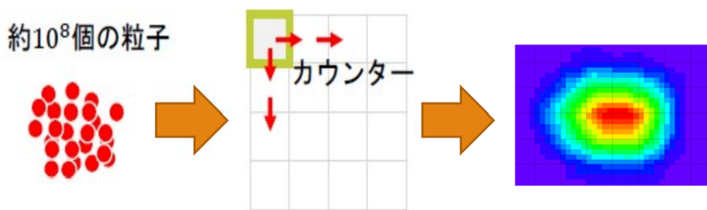
図 3.2: パルスビームに対してソロカウンター方式を用いた場合
