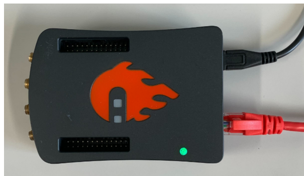
図 3.15: Redpitaya. 黒線が電源ケーブル, 赤線がイーサネットケーブル.
