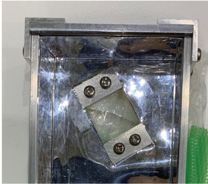
図 3.6: アクリル設置の様子. 底に窓を設けている.
