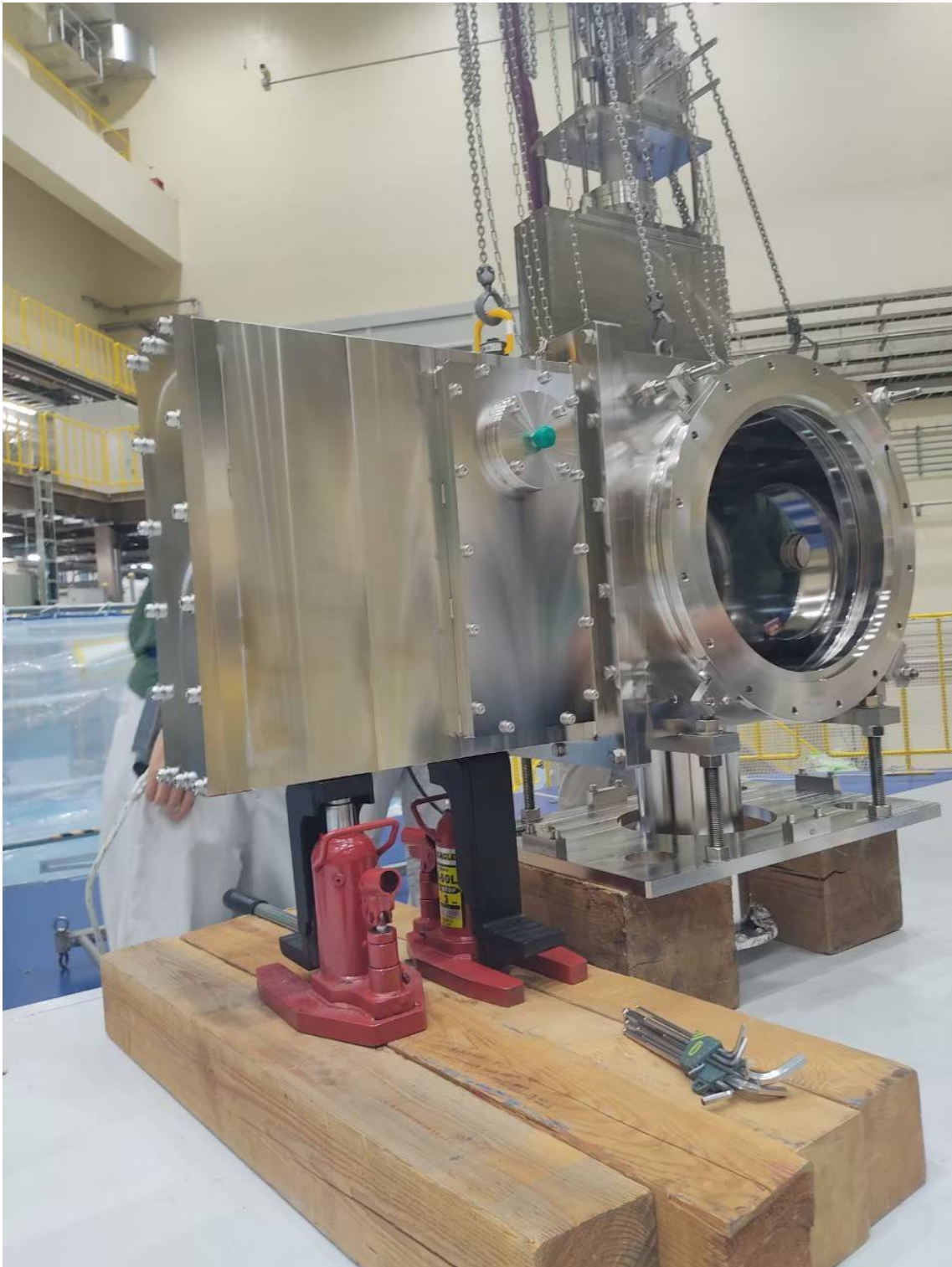
図 4.1: アルミ中間標的を挿入するダクトを撮影したもの。Al 中間標的は使用しない場合はダクト上部に飛び出た空間に収められており、使用する際は上から下に降ろす。ダクト左側に伸びている長方形の領域は、別の標的を収めるための空間である。
