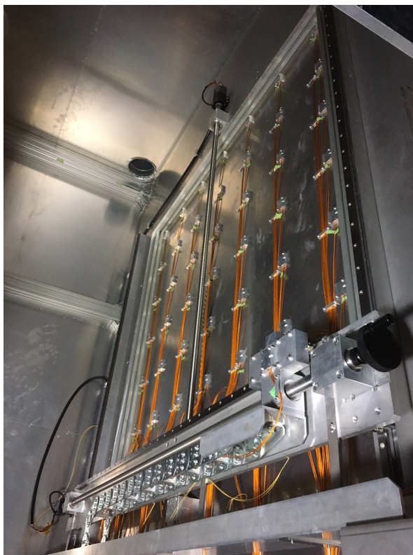
図 3.3: Si の写真.Si の本体はアルミケースで覆われている。右下の可動ステージ上に ref-Si が取り付けられている。
