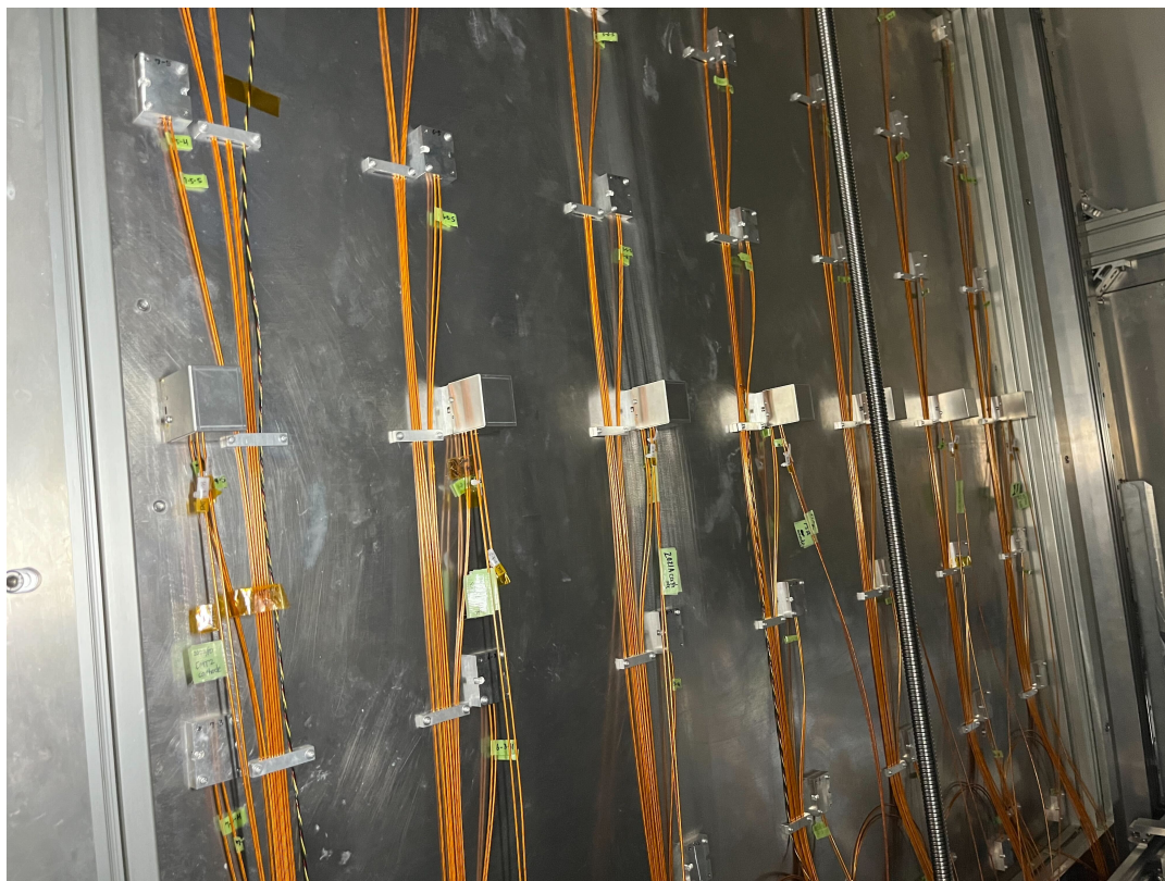
図 6.3: セットアップが完了した内部 EMT の写真. EMT の治具の上に小型のシャーシを被せている. 左から EMT74 → EMT14 の順番に取り付けられている.
