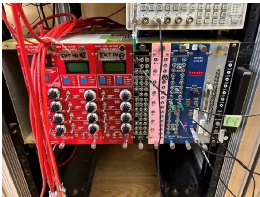
図 6.4: J-PARC の測定で使用した EMT の電源. NIM ラックに取り付けられている赤いモジュールが EMT の電源である. 今回用いたのは左から 2 つ目のモジュールで林レピック社の RPH-034 である.
