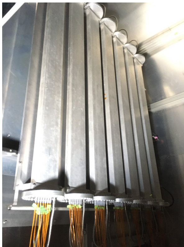
図 3.7: IC の写真。1 本の管に 7 個のセラミックプレートが入っている。
